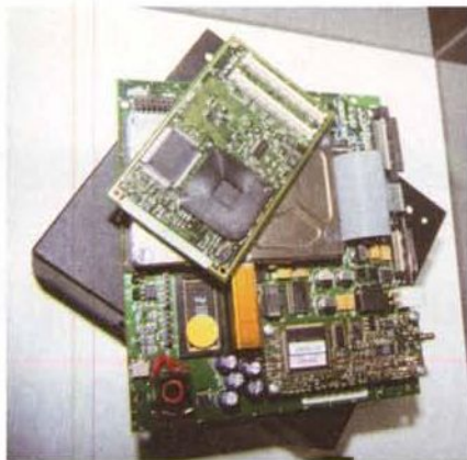
In primo piano il processore di classe Pentium Mobile MMX, sullo sfondo l'hard disk.
